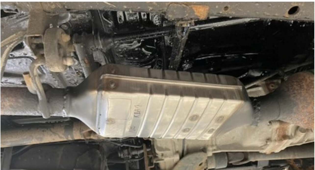
DPF monteret imellem katalysator og ophæng. Flange fjernet (Foto: Frejlev Auto)
