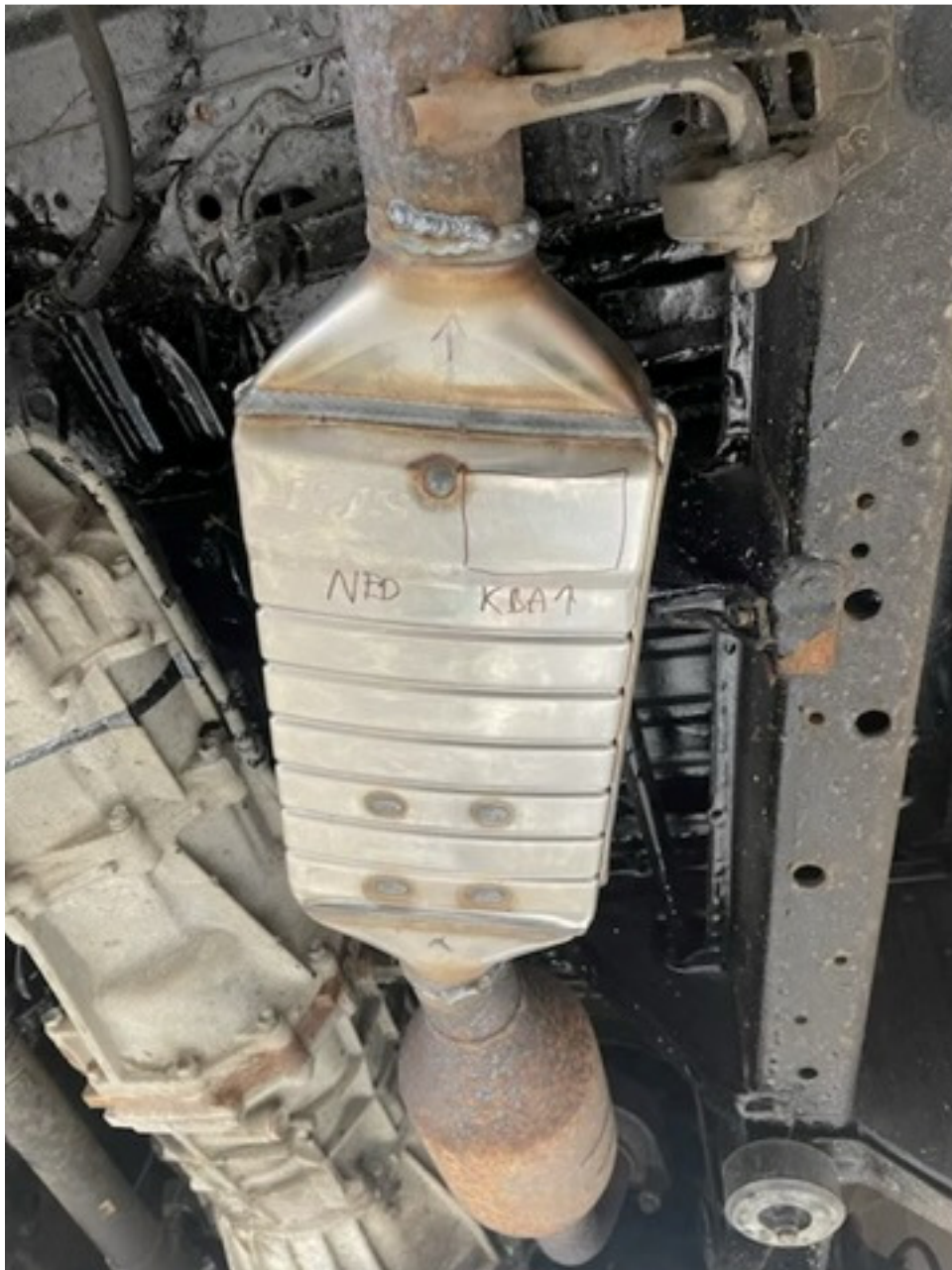
DPF monteret imellem katalysator og ophæng. Flange fjernet (Foto: Frejlev Auto)
